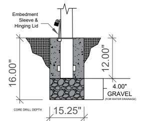
CORE DRILL MINIMUM DIAMETER
